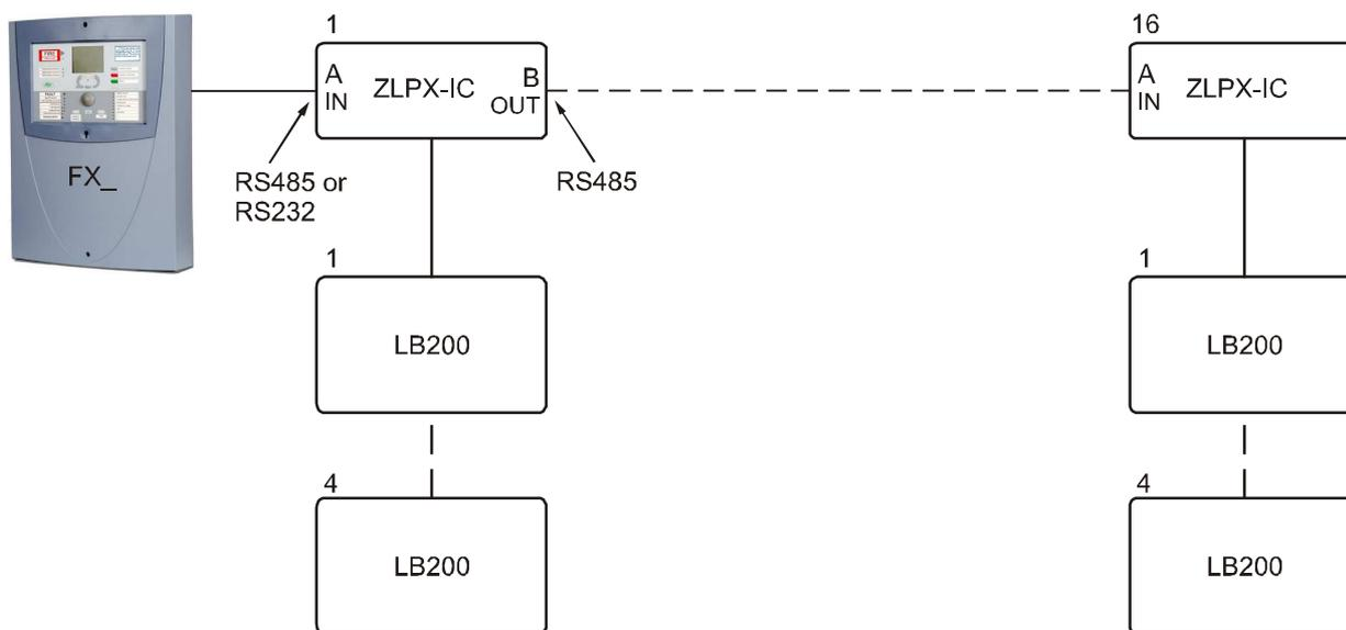
**Внимание!** Максимальное число панелей ZLPX (и/или ZLPX-IC; FMPX, REPX, REPX-OB, MCOX, MCOX-OB), подключенных к одной панели серии FX NET/RU, должно быть не более 16. Для конфигурирования и обновления внутреннего ПО используется входной порт RS232 (A/IN). Во время конфигурирования ZLPX (ZLPX-IC) линия INFO должна быть отключена.
