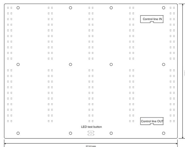
**Примечание!** При нажатии кнопки “LED test button” все светодиоды загорятся на 5 секунд.
