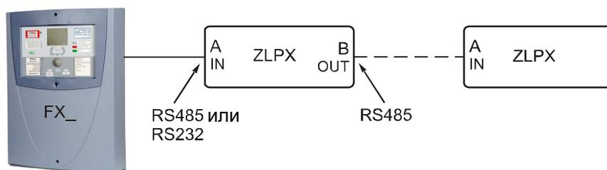
**Внимание!** К одной панели серии FX NET/RU можно подключить максимум 16 устройств FMPX, REPX, REPX-OB, MCOX, MCOX-OB, ZLPX, ZLPX-IC.
