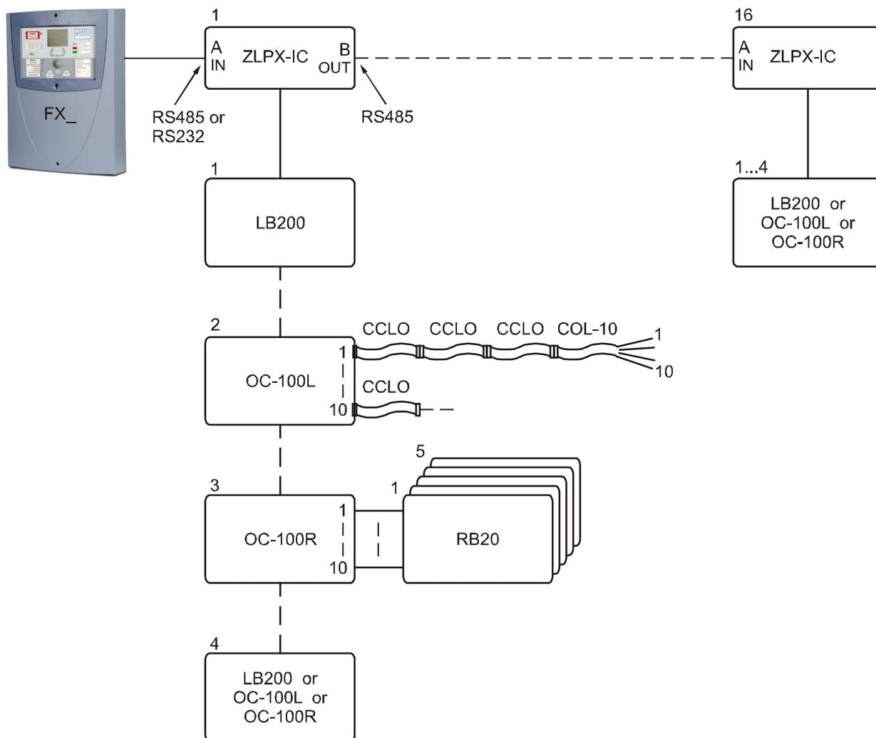
**Внимание!** Максимальное число панелей ZLPX (и/или ZLPX-IC; FMPX, REPX, REPX-OB, MCOX, MCOX-OB), подключенных к одной панели серии FX NET/RU, должно быть не более 16. Для конфигурирования и обновления внутреннего ПО используется входной порт RS232 (A/IN). Во время конфигурирования ZLPX (ZLPX-IC) линия INFO должна быть отключена.
