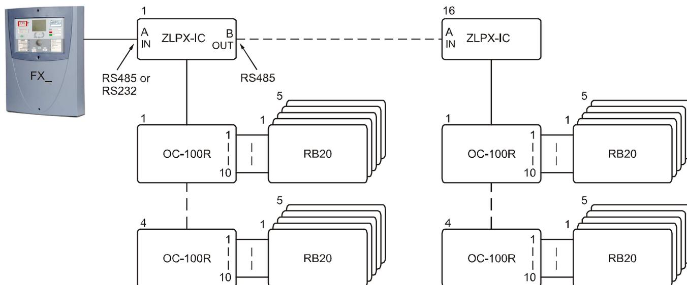
**Внимание!** Максимальное число панелей ZLPX (и/или ZLPX-IC; FMPX, REPX, REPX-OB, MCOX, MCOX-OB), подключенных к одной панели серии FX NET/RU, должно быть не более 16. Для конфигурирования и обновления внутреннего ПО используется входной порт RS232 (A/IN). Во время конфигурирования ZLPX (ZLPX-IC) линия INFO должна быть отключена.
